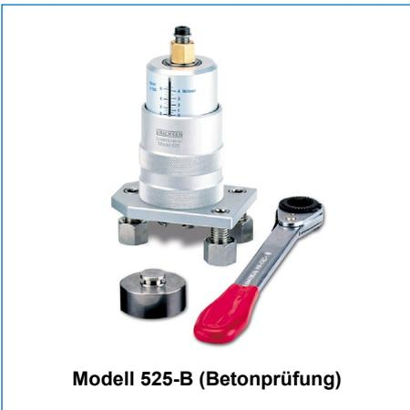
Modell 525-B (Betonprüfung)
