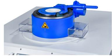
Alle Komponenten sind von außen gut zugänglich, somit lassen sich auch die Werkzeuge für die jeweiligen Tests schnell wechseln. Die klare und übersichtliche Menüführung via Touchpanel (99 frei programmierbare Programme und Werkzeugwechsel) hat Passwort-geschützte Ebenen, die vor unbefugten Zugriffen schützen.
