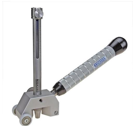
Der langjährig bewährte ERICHSEN Härteprüfstab 318 ist bereits vor Jahren in Form der parallel erhältlichen Ausführung 318 S mit rollendem Prüfkopf entscheidend verbessert worden. Die noch immer erhältliche Ausführung 318 mit hülsenförmigen Kopfstück kann mit dem **Einspann-Adapter** ideal senkrecht und ohne Berührung durch die Hülsenkante, über die zu prüfende Oberfläche geführt werden.
