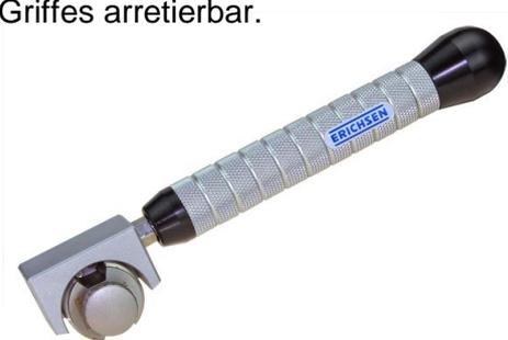
Abb. Griff mit Gitterschnittadapter
