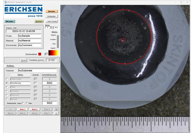
Per Cursor werden nun Kontrastlinien positioniert, d.h. am Übergangsktrast von Substrat zur Beschichtung, sowie an der Oberkante der Beschichtung.
