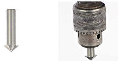
Die Bohrung erfolgt bei angemessen niedriger Drehzahl (ggf. gemäß erzieltm Resultat individuell zu optimieren) möglichst senkrecht durch die zu messende Schicht hindurch, bis der Untergrund sichtbar (beim Bohren ggf. spürbar) erreicht wird; gerade bei mineralischen Substraten **NICHT** deutlich in den Untergrund hinein.
