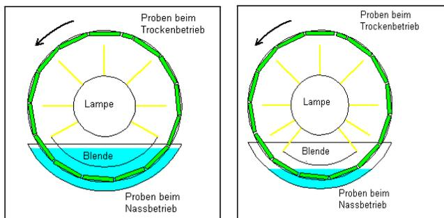
Die Mitteltemperaturhomogenität und -strahlung auf jeder ausgesetzten Probe sind durch die Rackdrehung rund um die horizontale Achse sichergestellt. Damit ergibt sich eine ideale Reproduzierbarkeit und Zuverlässigkeit der Prüfung. Ein Vorteil ist hier die außergewöhnlich breite Bestrahlungsoberfläche (mehr als 100 Proben von je 1 cm Breite möglich).
