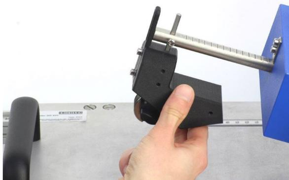
Es stehen drei Schneidkörper mit unterschiedlichen Schnittabständen zur Auswahl (6x1 mm, 6x2 mm oder 6x3 mm), wobei jeder Schneidkörper mit **vier** Schneidkanten versehen ist, was nach erfolgtem Verschleiß einen insgesamt dreifachen Wechsel auf die nächste scharfe Schneidkante gestattet.
