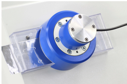
Kamera mit Magnethalterung für die Risserkennung
