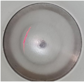
Risserkennung mit dem beleuchteten Kugelstößel
